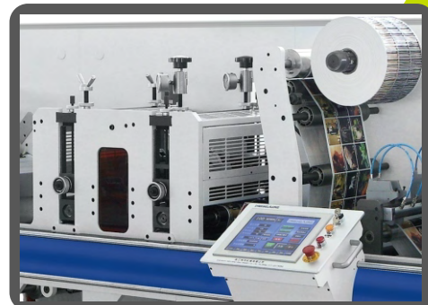
Estación de troquelado
